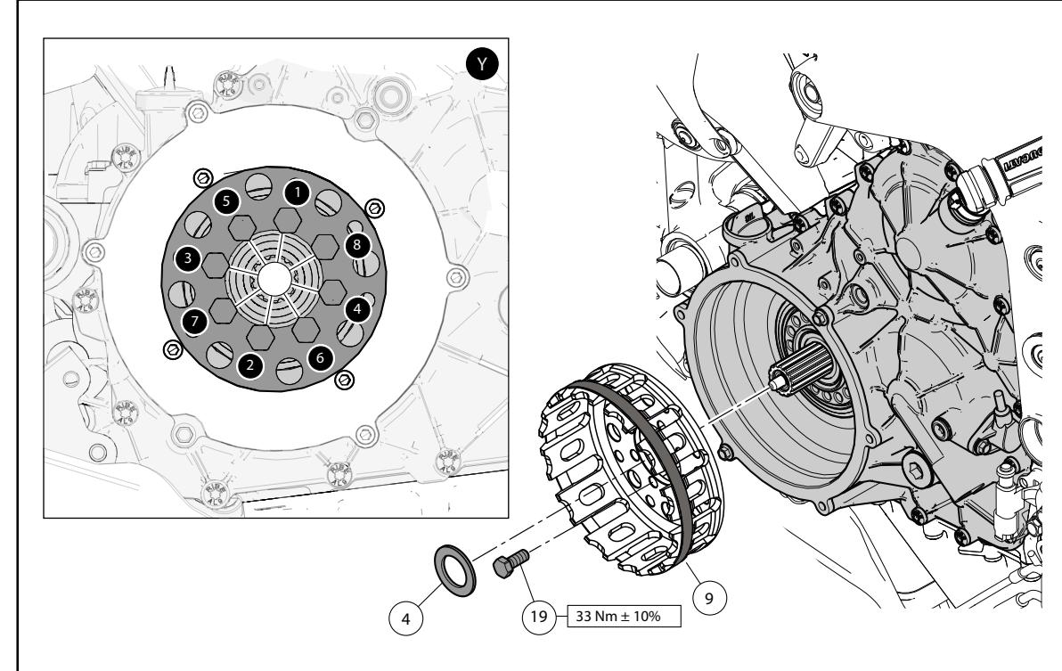
Inserire la campana frizione (9), allineando i fori filettati di fissaggio. Applicare LOCTITE 243 sul filetto delle n.8 viti (19) ed impuntarle.
