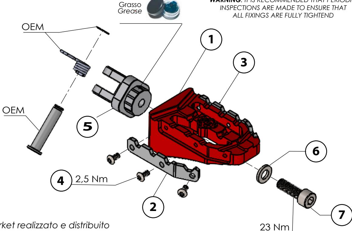
**ATTENZIONE:** SI RACCOMANDA DI EFFETTUARE ISPEZIONI PERIODICHE PER VERIFICARE CHE TUTTI I FISSAGGI SIANO COMPLETAMENTE SERRATI
