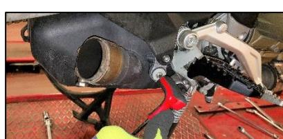
**ITA** Svitare le viti di fissaggio al telaio del catalizzatore originale
