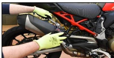
**ITA** Svitare la vite di fissaggio del silenziatore e rimuoverlo lasciando la fascetta originale sul catalizzatore originale
