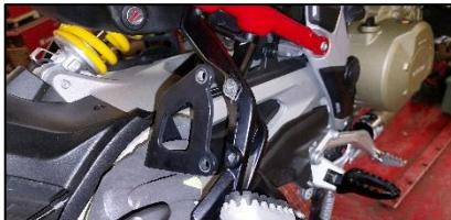
**ITA** Posizionare la staffa in dotazione( Rif 7) e fissare con le viti ( Rif 17) senza serrare
