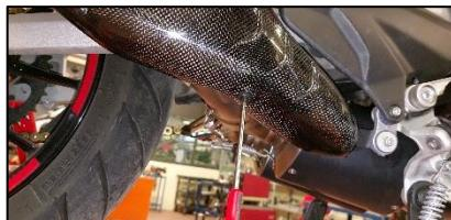
**ITA** Avvitare la vite inferiore ( Rif 22)
