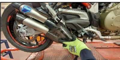
**ITA** Posizionare il paracalore ( Rif 5) sul silenziatore e fissare con le viti ( Rif 8)
