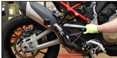
**ITA** Svitare la vite di fissaggio e rimuovere il paracalore
