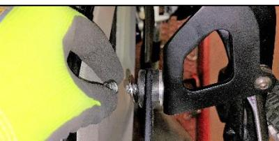
**ITA** Fissare la staffa al telaio mediante la vite + rondella estetica (Rif 20-19) rondella e dado (Rif 21-18) senza serrare
