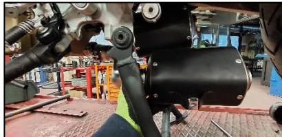
**ITA** Inserire il pre silenziatore SX (Rif2) sul collettore orizzontale e fissare al telaio con la vite originale senza serrare
