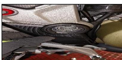
**ITA** Svitare le viti di fissaggio della pedana
