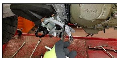
**ITA** Rimontare la pedana e il collettore orizzontale, ricordandosi di fissare le sonde lambda
