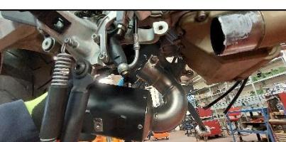
**ITA** Inserire il presilenziatore DX (Rif 1) sul collettore verticale e fissare al telaio con le viti di serie senza serrare
