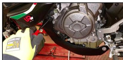
**ITA** Svitare le viti di fissaggio del paramotore
