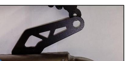
**ITA** Sulla staffa del silenziatore ( Rif 3 ) inserire il silent block in gomma maschio ( Rif 14) sul lato interno, la rondella in gomma ( Rif 23) e il distanziale in alluminio ( Rif 23)sul lato esterno come in figura
