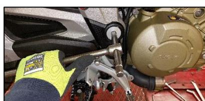
**ITA** Rimuovere la copertura, svitare la vite e togliere la protezione del telaio
